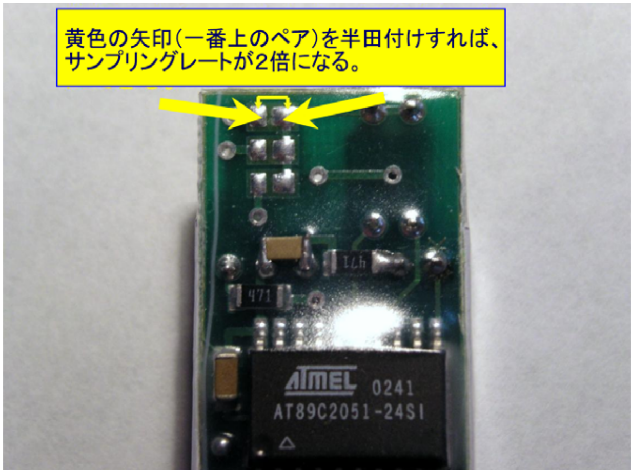
図 ハードウェアの改造によるサンプルングレートの変更
