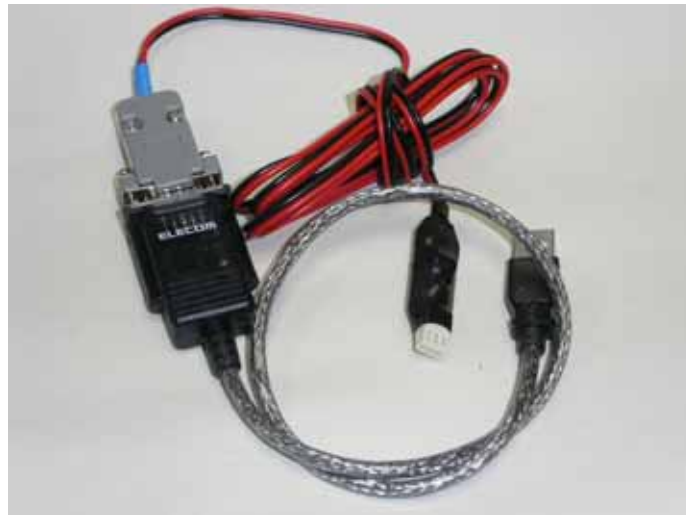
図 USB-RS232C コンバータとシリアルインタフェースケーブルの接続 (ELECOM 社、アイオーデータ社の製品は動作確認済み)
